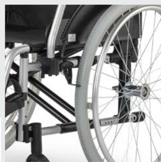
Stabilité accrue grâce à l'utilisation de doubles croisillons
