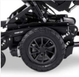
Traction centrale pour une grande maniabilité et des manœuvres précises
